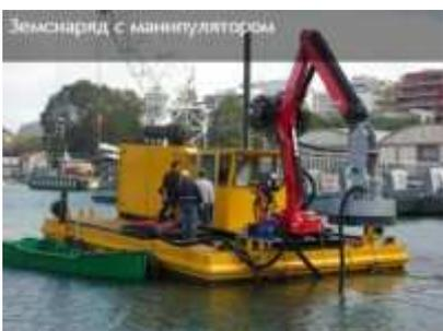
**DRT - ЗЕМСНАРЯД С НАСОСОМ НА ТЕЛЕСКОПИЧЕСКОМ ГИДРОМАНИПУЛЯТОРОМ.**
