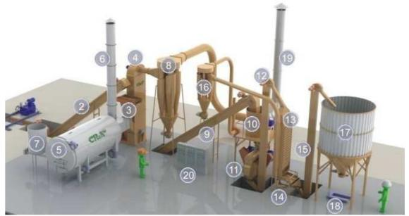
Завод по производству гранулированных сапропеле-витаминных кормов из высокоорганического сапропеля и травы. Основан на Агрегате сушки-измельчения АС-4-1500. Измельчение и высушивание сапропеля и травы происходит за 2 ... 3 секунды, что обеспечивает максимальную сохранность витаминов.
