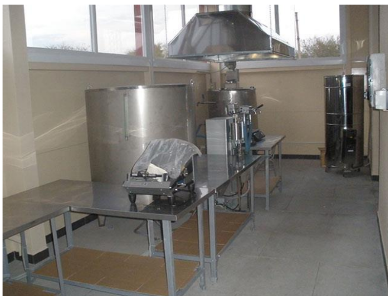
Лабораторная установка для получения гумата калия из торфа
