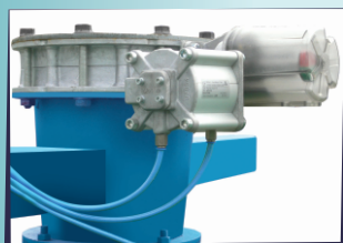
Надежная заслонка с пневмоприводом
