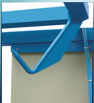
Удобное крепление мягкого контейнера к раме весового дозатора
