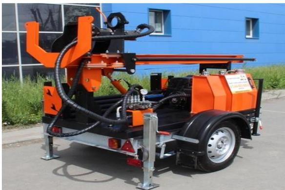
Бурение технологической скважины большого диаметра выполняется миниустановкой на самоходном или прицепном шасси, имеющей автономный дизельный привод.
