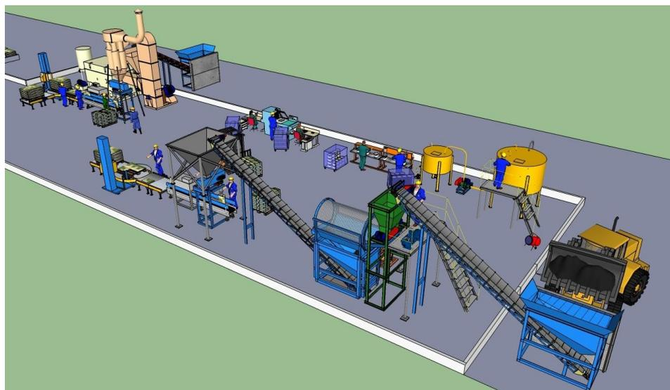
Оборудование комплекса состоит из добычного, перерабатывающего, подсушивающего и фасовочного узла.
