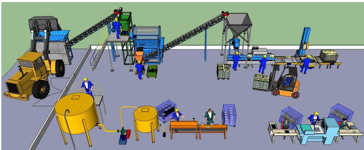
Оборудование комплекса состоит из добычного, перерабатывающего, подсушивающего и фасовочного участков.
