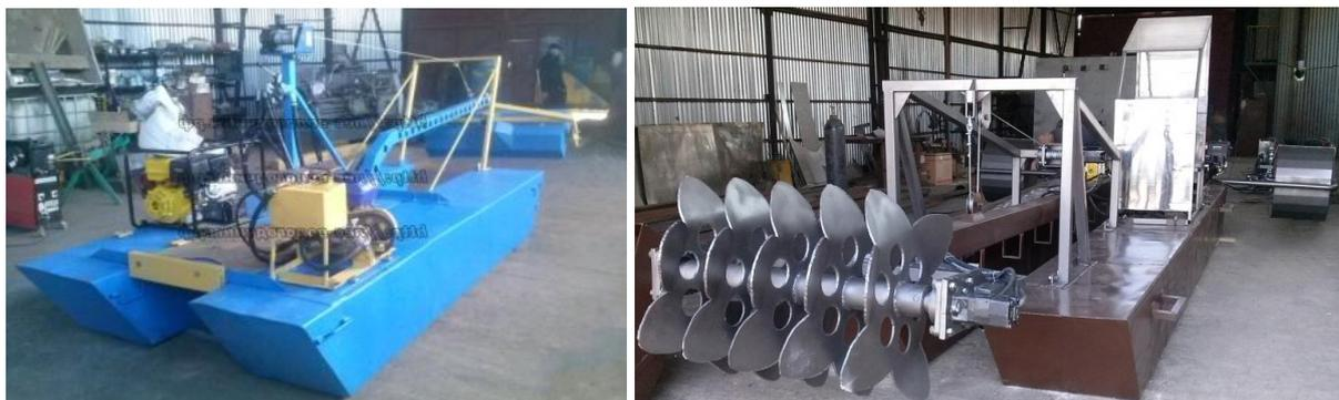
Очистка водоема осуществляется миниземснарядом, который позволяет очищать водную поверхность от растительности, а сам водоем - от донных илов, извлекать их и подавать на подготовку и переработку. Подготовка извлекаемой растительно-иловой массы, обычно, включает в себе ее доставку на берег и обезвоживание, подсушку до требуемой влажности, подачу массы на переработку и последующую фасовку с упаковкой готового продукта.
