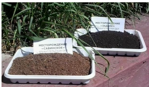
Компоненты для производства торфо-сапропелевых сорбентов (ТСС) в кассетные фильтры очистки стоков
