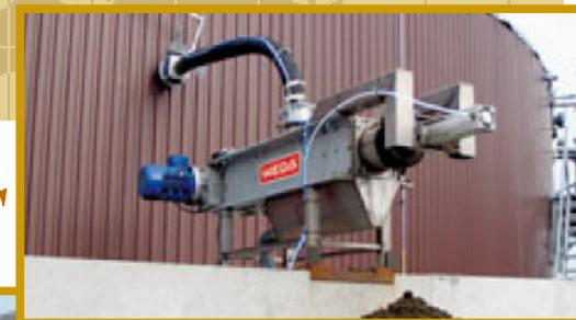
С механизмом CombiPress возможны разнообразные варианты установки. В биогазовой установке сепарация веществ происходит непосредственно после их выхода из ферментера.
