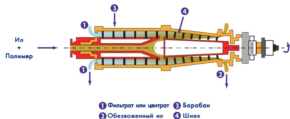
Необходимо уточнить некоторые параметры, присущие обезвоживанию на центрифуге, так как они фигурируют в лабораторных и производственных испытаниях по выбору полимера.
