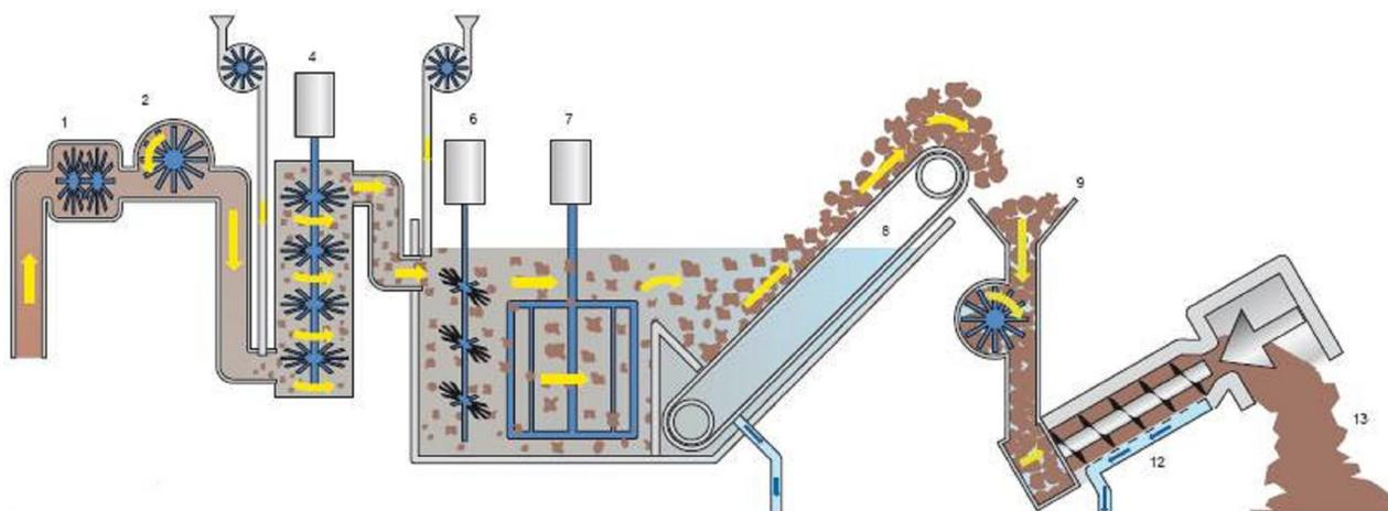
Результат обезвоживания сапропеля на предлагаемом оборудовании: влажность твердой фракции от 82 до 60%. Используя дополнительные мероприятия в процессе можно достичь конечную влажность продукта-сырца 45-50%.
