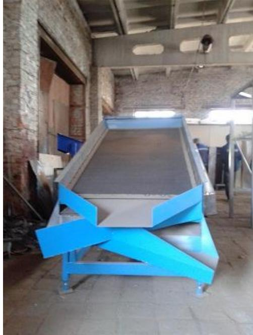
Применение вибросита ВС позволяет произвести разделение материалов на необходимые фракции, в зависимости от установленной сменной сетки. Вибросито предназначено для разделения на фракции сыпучих материалов, не склонных к налипанию, согласно существующему технологическому регламенту.
