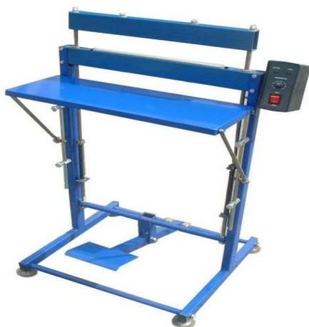
Паечный узел приводится в действие с помощью ножного привода, что освобождает оператора обе руки для работы с изделиями. Максимальная производительность, которую позволяет развить данный тип привода и паечного узла, составляет около 4 000 швов за смену.
