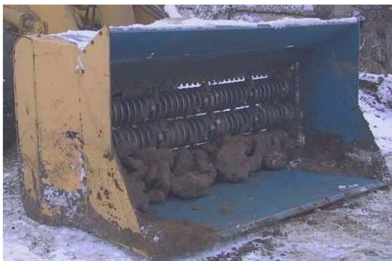
Ковш дробильный ЗТМ-262 предназначен для измельчения мерзлого грунта, сапропеля, торфа, механической их смеси.
