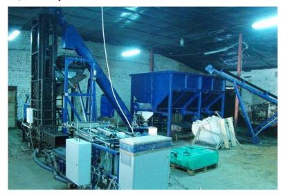
Предназначение: Для полуавтоматического/автоматического дозирования и упаковки продукции в брикеты в ПЭ или бумажные мешки.
