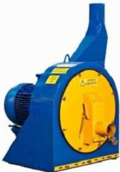
Молотковые дробилки ДКР предназначены для измельчения мелкокусковых отходов. Благодаря двухкамерной конструкции достигается высокая скорость и однородность измельчения. Дробилка снабжена пневматической загрузкой и выгрузкой материала: сырьё и измельчённый продукт перемещаются с воздушным потоком по гибким трубопроводам, что помогает избежать установки дополнительного транспортного оборудования и снизить общие энергозатраты.
