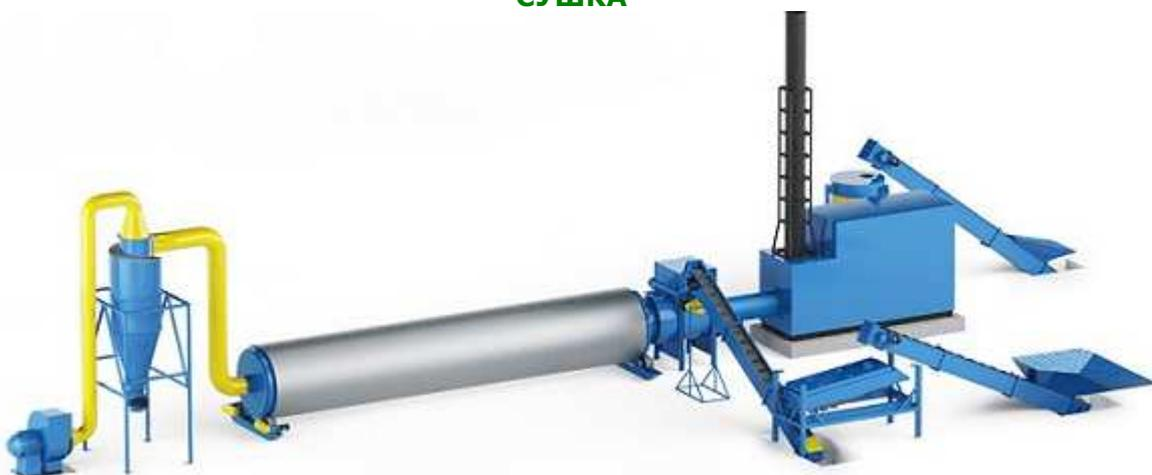
Сушильные комплексы барабанного типа зарекомендовали себя как надёжные и отказоустойчивые решения. Благодаря прямому контакту сушильного агента с сырьём достигается высокий тепловой КПД и высокий процент снятия влаги, позволяющий просушивать даже сильновлажное сырьё. За счёт усиленного перемешивания материала внутри барабана достигается равномерный нагрев всех частиц.
