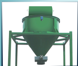
Промежуточный бункер на раме с ножевым затвором и датчиком уровня
