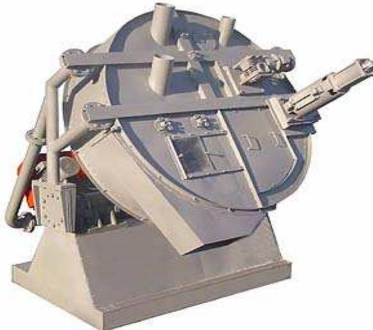
Тарельчатые Грануляторы могут поставляться в комплекте с бункерами для сыпучих продуктов, емкостями для приготовления и хранения связующего, системами дозирования жидких и твердых компонентов, КИП и А, составляющих установку гранулирования
