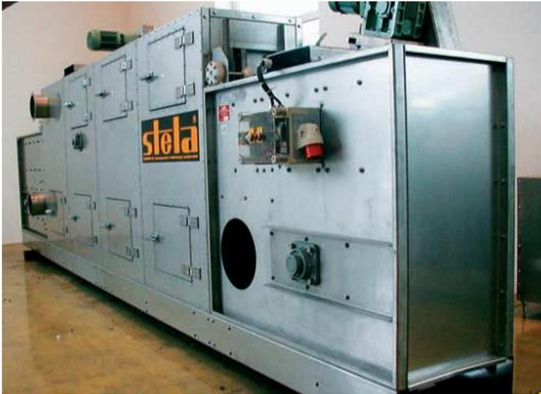
Время пребывания в зоне сушки регулируется с помощью частотного механизма управления с точностью до минуты. Вместе с тем, сушилка может быть идеально приспособлена к самым разным требованиям (пропускная способность, содержание сухого вещества, температура сушки). Равномерная сушка гарантирует гомогенную структуру продукта и производит высококачественный, чистый гранулят, который хорошо подходит для всех возможных путей утилизации и использования.
