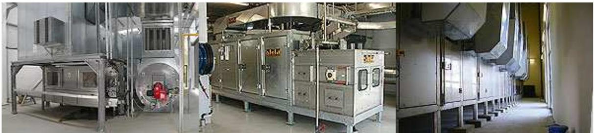
Механическим путем до прибл. 20%– 30% TS- показателей сухого вещества обезвоженная отстойная грязь, прессуется с помощью специального экструдера в веревочную форму. Пеллеты, колбасковидной формы, попадают прямо на перфорированную конвейерную ленту и образуют хорошо продуваемую воздухом укладку. Она поступает в туннель сушки, где сквозь него проходит теплый воздух и сушит щадящим способом.
