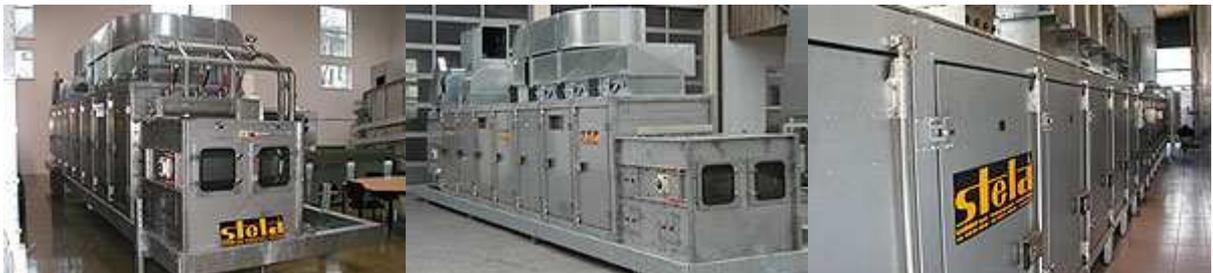
Продукт медленно передвигается на ленточном конвейере по туннеле сушки. Таким образом, сводится до минимума механическая нагрузка (например разворачивающая, срезающая или центрифугирующая). Это особенно важно для безущербного прохождения продуктом фазы его сушения.
