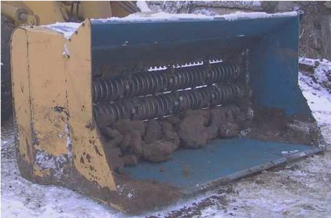
Предназначен для измельчения мерзлого грунта, кирпича, асфальта, не армированного бетона и других строительных отходов.
