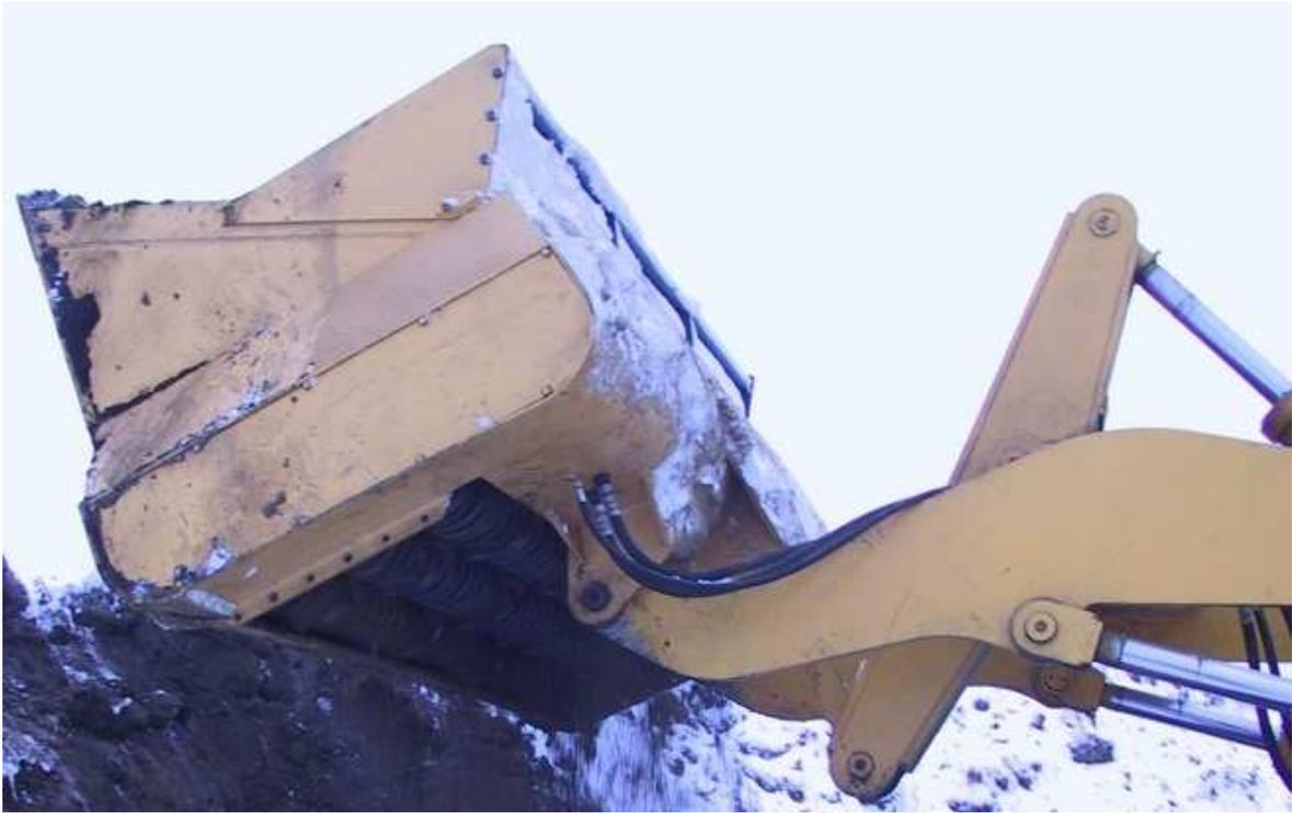
Предназначен для измельчения мерзлого грунта, кирпича, асфальта, не армированного бетона и других строительных отходов.
