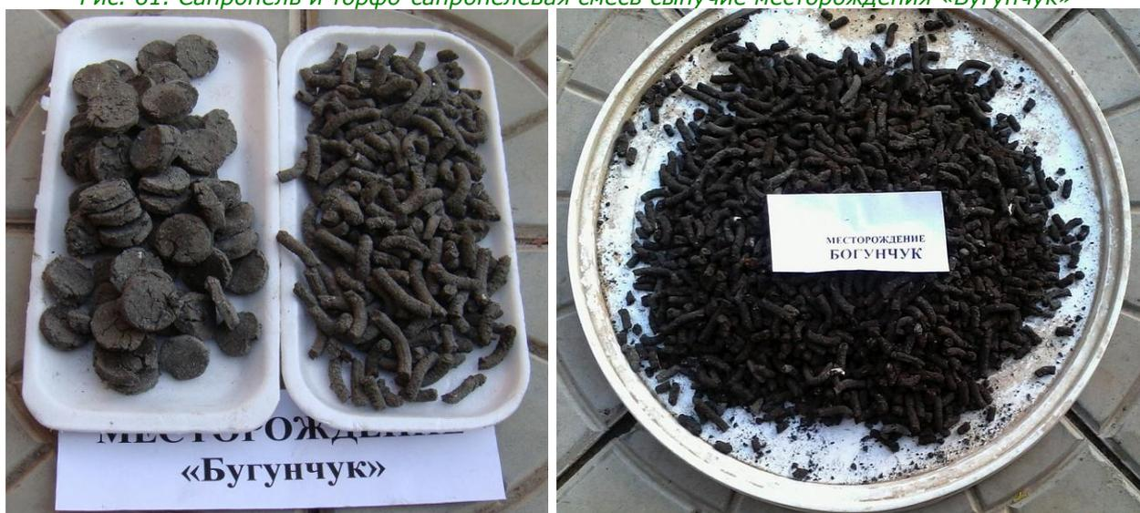
Рис. 62. Сапропель и торфо-сапропелевая смесь гранулированные и таблетированные месторождения «Бугунчук»
