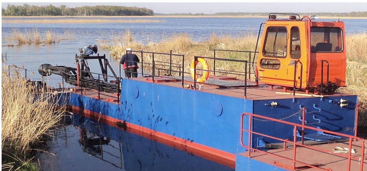
Рис. 73. Земснаряд проекта 258.60-2СШ
