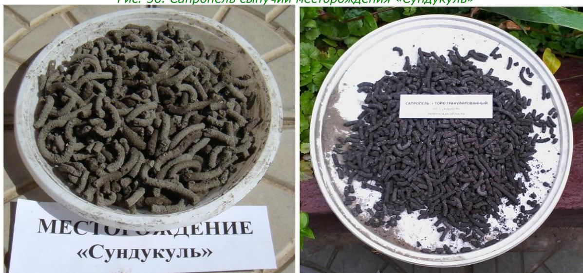
Рис. 57. Сапропель и торфо-сапропелевая смесь гранулированные месторождения «Сундукуль»
