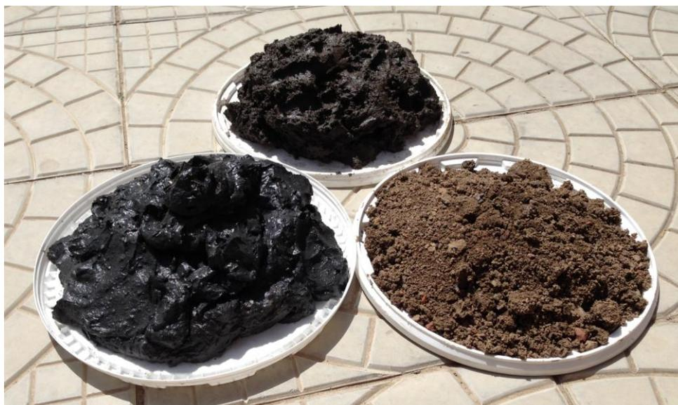
Рис. 45. Пробы сапропеля из озер Сундукуль и Бугунчук, грунта с площади рекультивации на физико-химический анализ
