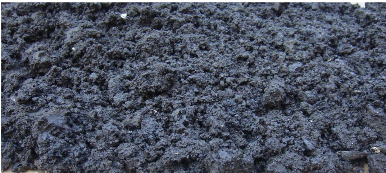
*Рис. 38. Сапропель валовой пробы после двухкратного 12-дневного промораживания-оттаивания при температуре -18\*С*
