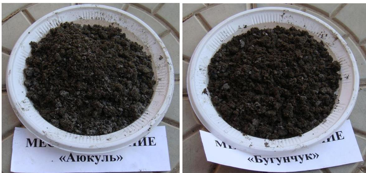
Рис. 40. Промороженный сапропель и просеянный в ковшовой дробилке перед фасовкой в мешки
