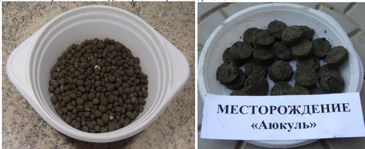
*Рис.39. Опытные образцы гранулированного и таблетированного сапропеля*
