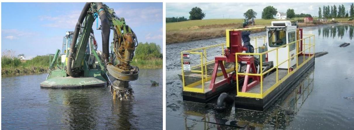
Рис. 7. Оборудование добычи сапропеля
