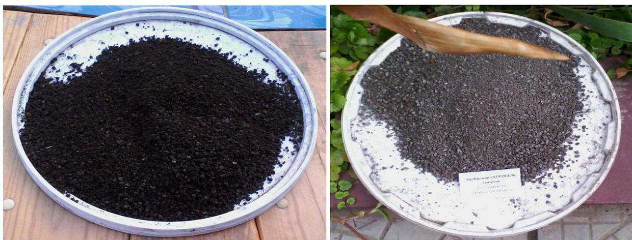
Рис.49. Сапропелевый рекультивант полученный на дезинтеграторе ДС-3000 Вига-Турбо
