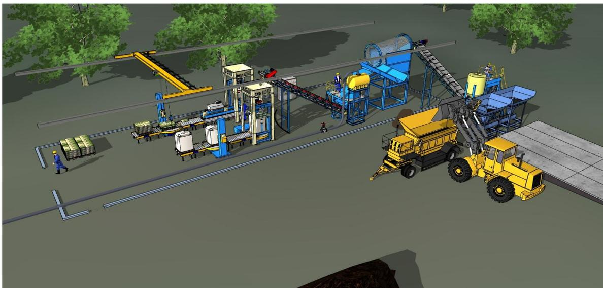
Рис. 93. Добычное и перерабатывающее оборудование в производстве рекультивантов на основе сапропеля или продуктивного донного ила
