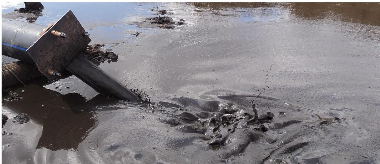
Рис. 74. Истечение сапропеля естественной влажности при добыче
